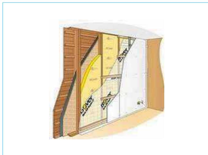
**Figure 12 – Isolant en une couche entre montants Isover (source : Saint-Gobain)**
