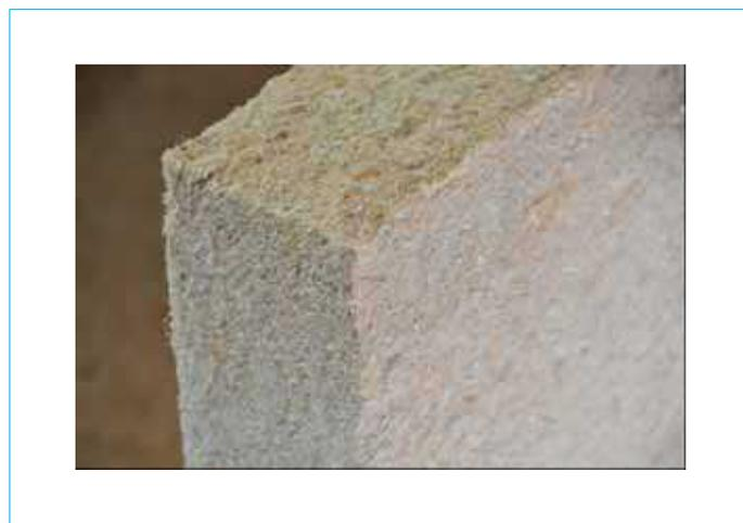
Figure 8 – Ouate de cellulose (source : Biofib)
